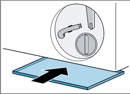
6. Den Entleerungsschlauch aus der Halterung nehmen.
