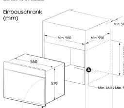
Der Einbauschrank muss über Lüftungsöffnungen (A) verfügen, um die Wärme abzuführen und die Luft zirkulieren zu lassen.
