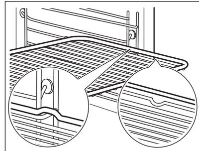
Schieben Sie den Rost zwischen die Führungsstäbe der Einhängegitter. Stellen Sie sicher, dass der Rost die Rückseite des Garraums berührt.
