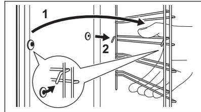
4. Setzen Sie die Einhängegitter in umgekehrter Reihenfolge ein.
