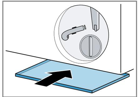
6. Den Entleerungsschlauch aus der Halterung nehmen.
