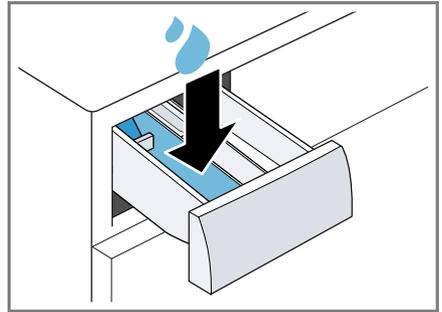
6. Pulvervollwaschmittel in die Kammer II einfüllen.
