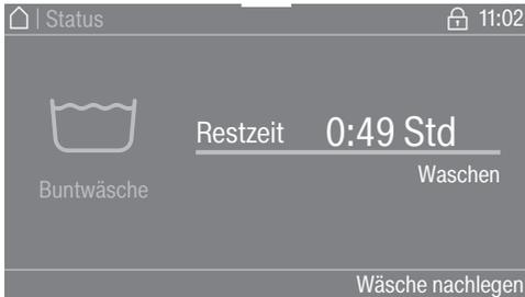
Bei einer Temperatur von über 55 °C in der Trommel bleibt die Türverriegelung aktiv. Erst nach Absinken der Temperatur auf unter 55 °C wird die Türverriegelung deaktiviert.
