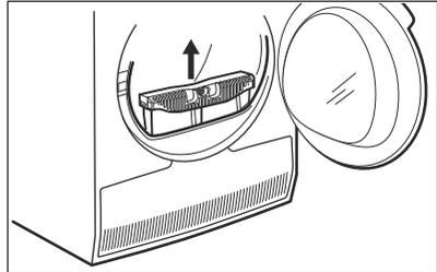
2. Öffnen Sie die Kondensatorabdeckung.
