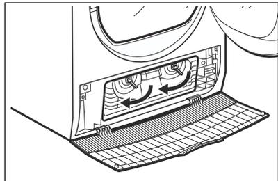
4. Klappen Sie den Kondensatordeckel nach unten.
