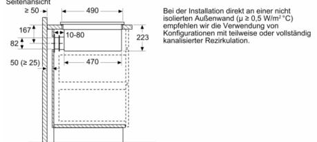
Bei der Installation direkt an einer nicht isolierten Außenwand ( $\lambda > 0.5 \text{ W/m} \cdot \text{K}$ ) empfehlen wir die Verwendung von Konfigurationen mit teilweise oder vollständig kanalisierten Rezirkulation.
