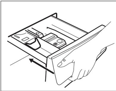
Vergewissern Sie sich, dass die Klappe beim Schließen der Schublade nicht blockiert wird.
