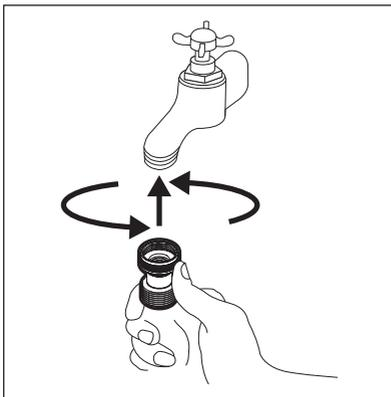
5. Schließe den Zulaufschlauch an das Ventil an. Ziehe die Ringmutter fest, um Leckagen zu vermeiden.
