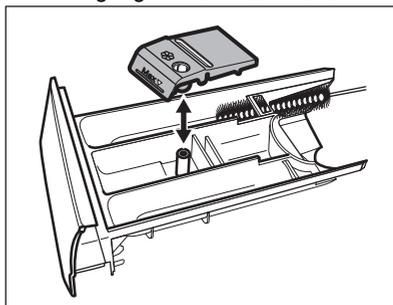
3. Stellen Sie sicher, dass alle Waschmittelreste an der Ober- und Unterseite der Aufnahme entfernt wurden. Reinigen Sie die Schubladenaufnahme mit einer kleinen Bürste.
