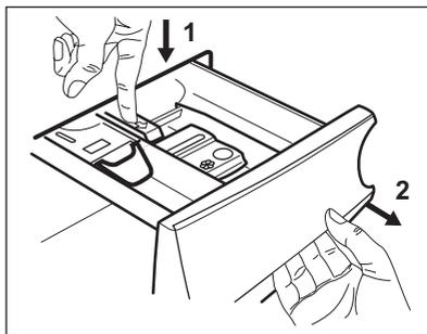
2. Entfernen Sie das Oberteil des Pflegemittelfachs, um die Reinigung zu vereinfachen, und spülen Sie es mit fließendem warmen Wasser aus, um das angesammelte Waschmittel zu beseitigen. Setzen Sie nach der Reinigung das Oberteil wieder ein.
