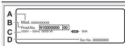
Das **Typenschild** gibt den Modellnamen (**A**), die Produktnummer (**B**), die elektrischen Nennwerte (**C**) und die Seriennummer (**D**) an.
