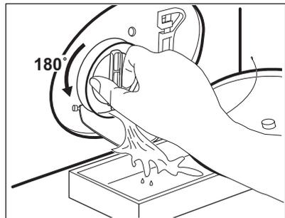
5. Wenn der Behälter voll ist, drehen Sie das Sieb zurück und leeren Sie den Behälter.
