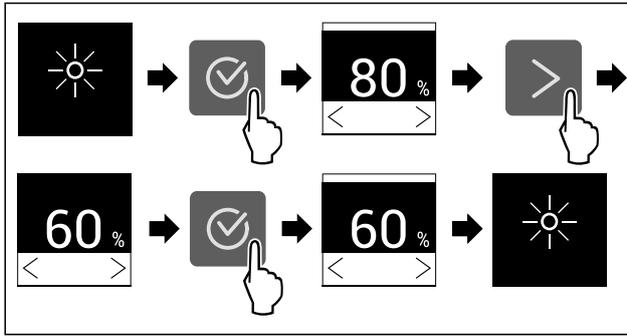
Fig. 56 Beispielhafte Darstellung: Von 80 % zu 60 % wechseln.
