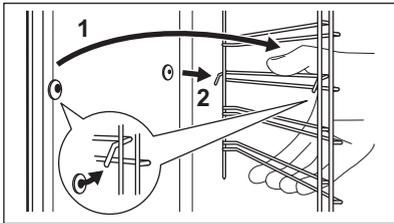
4. Setzen Sie die Eihängegitter in umgekehrter Reihenfolge ein.
