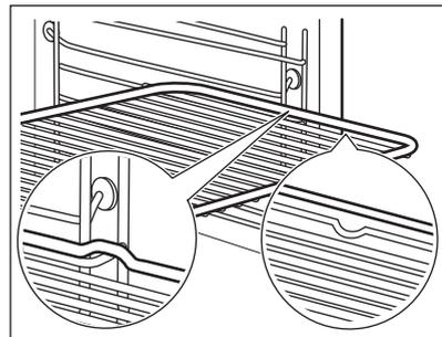
Schieben Sie den Rost zwischen die Führungsstäbe der Einhängegitter. Stellen
