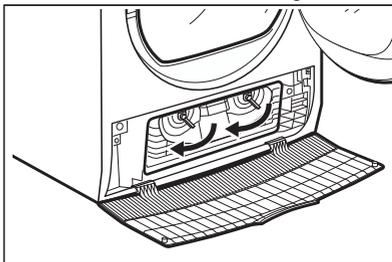
4. Klappen Sie den Kondensatordeckel nach unten.
