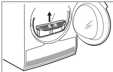
2. Öffnen Sie die Kondensatorabdeckung.
