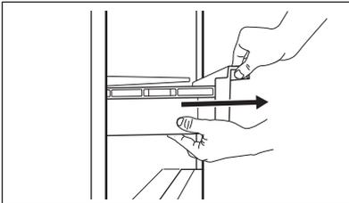
2. Heben Sie die Vorderseite der Schublade an.
