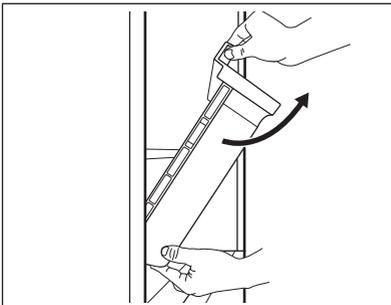
3. Heben und drehen Sie die Schublade, um sie aus dem Gerät zu ziehen.
