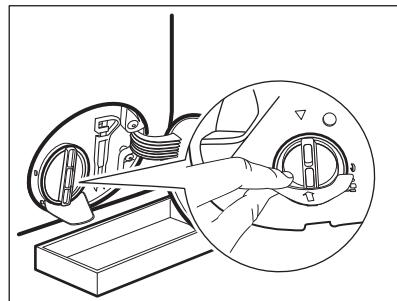
4. Drehen Sie das Sieb um 180 Grad gegen den Uhrzeigersinn, um es zu öffnen und entfernen Sie es nicht. Lassen Sie das Wasser ablaufen.
