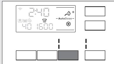
Ist der automatische Waschmitteltank ausgeschaltet, kann diese Option wie in einer herkömmlichen Waschmaschine durch manuelles Einfüllen von Wasch- oder Pflegemittel in die Fächer zur manuellen Befüllung benutzt werden.
