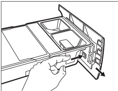
9. Stellen Sie sicher, dass alle Waschmittelreste an der Ober- und Unterseite der Aufnahme entfernt wurden. Reinigen Sie die Schubladenaufnahme mit einer kleinen Bürste.
