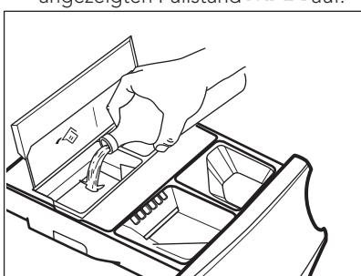
4. Gießen Sie nur flüssigen Weichspüler in den AutoDose Weichspülertank. Füllen Sie ihn bis zum maximal angezeigten Füllstand **MAX** auf.
