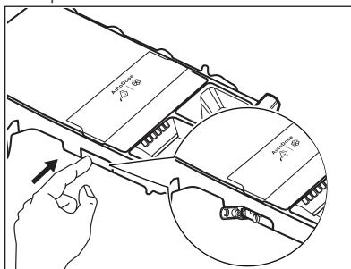
4. Drücken Sie auf die Arretierung hinten, siehe Abbildung, und heben Sie die obere Abdeckung an, um sie zu entfernen.
