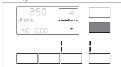
5. Tippen Sie zur Einstellung der Grunddosierung die entsprechenden Tanktasten, bis die Standard-Dosiermenge und zwei Pfeile unten im Display erscheinen. Berühren Sie die Taste Temp. wiederholt, um die Dosiermenge zu erhöhen und die Taste U/min, um sie zu verringern. Der kleinste Schritt beträgt 1 ml.
