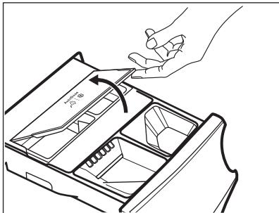
3. Gießen Sie nur Flüssigwaschmittel in den AutoDose Waschmitteltank. Füllen Sie ihn bis zum maximal angezeigten Füllstand **MAX** auf.
