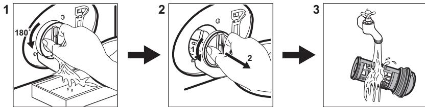
Reinigen Sie das Sieb regelmäßig und insbesondere, wenn der Fehlercode
