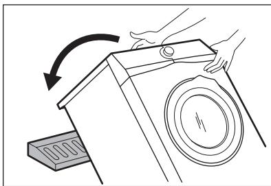
7. Entfernen Sie den Styroporschutz von der Geräteunterseite.
