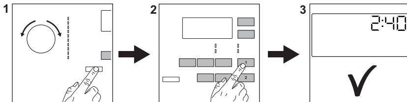
1. Drücken Sie zum Einschalten des Geräts die Taste **Ein/Aus**. Drehen Sie den Programmwahlschalter auf das gewünschte Programm.
