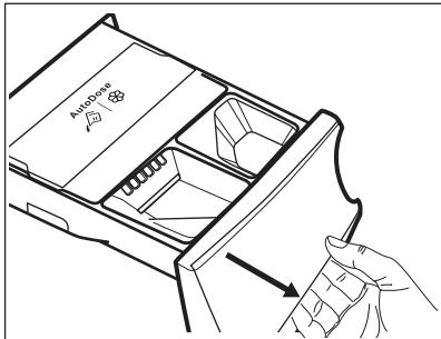
2. Geben Sie das Waschpulver in das Fach . Wenn Sie Flüssigwaschmittel verwenden, siehe „Manuelles Einfüllen von Flüssigwaschmittel“.
