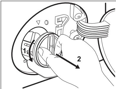
8. Entfernen Sie gegebenenfalls Flusen und Fremdkörper aus der Siebaufnahme.
