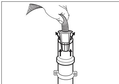
5. Ohne Kunststoffführung in einen Siphon - Stecken Sie den Ablauchschlauch in den Siphon und befestigen Sie ihn mit einer Schlauchschielle. Orientieren Sie sich an der Abbildung.
