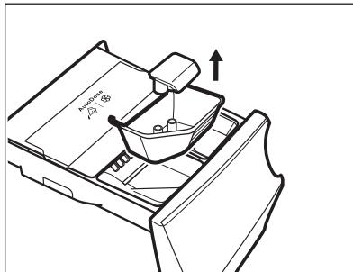
3. Öffnen Sie die Ablassstopfen der Tanks und leeren Sie sie in eine Spülung.
